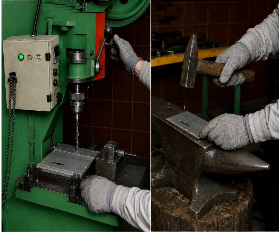
4. Matkap tezgâhında örs ve perçinleme işlemlerinin gerçekleştirilmesi
