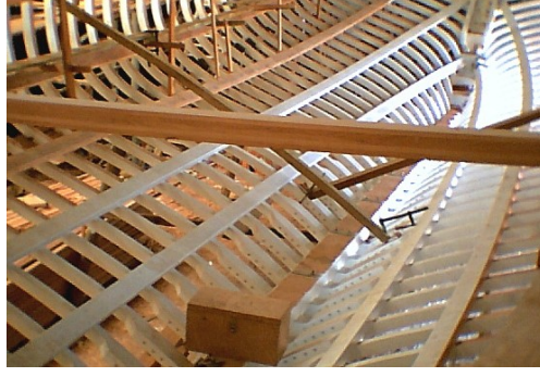
Şekil 1. Lamine yöntemle imal edilen bir Bodrum Guletine ait omurga, posta ve ıstralyalar
